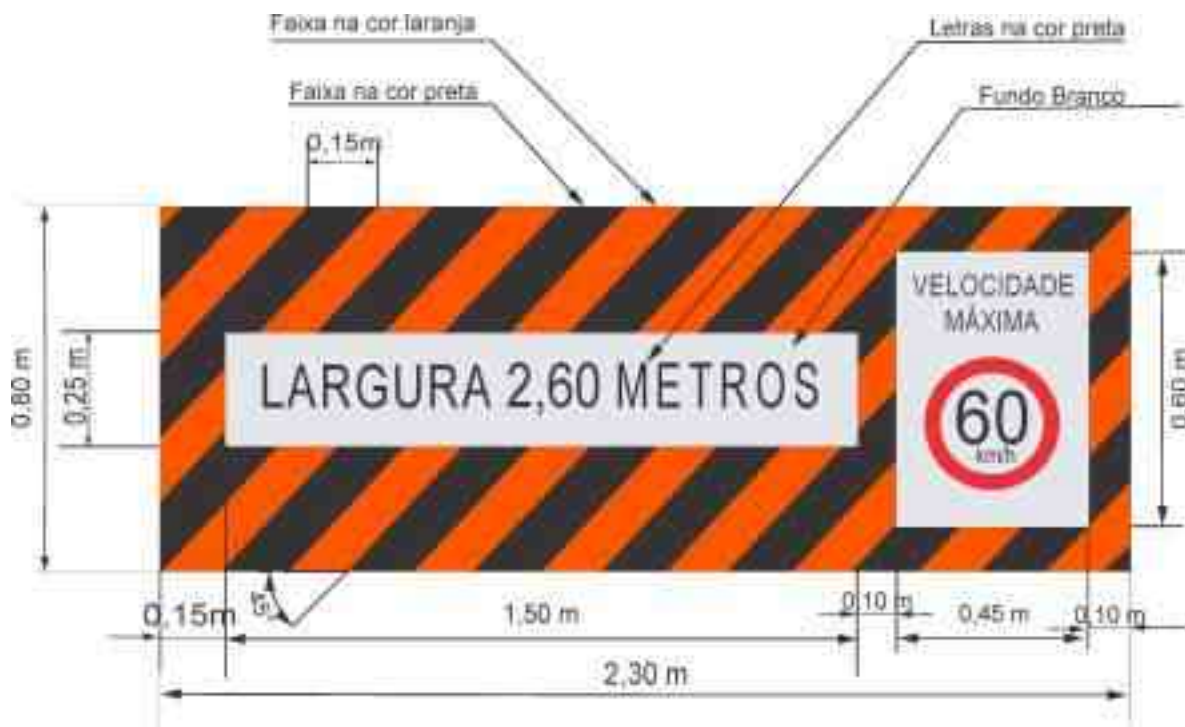
Figura 5: Sinalização especial de advertência traseira para largura excedente e limite de velocidade
