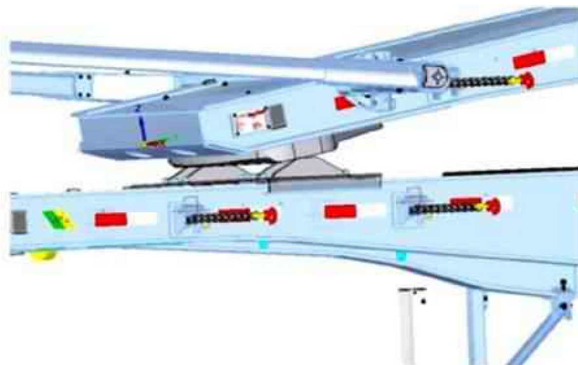
Figura 4: Amarração das cargas na parte da frente, por meio de sistema de pino-rei e quinta roda e de pino específico
