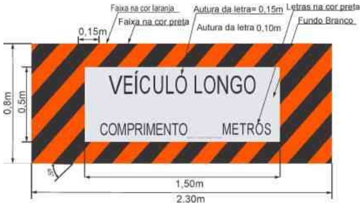
Figura 1: Sinalização especial de advertência traseira para comprimento excedente
