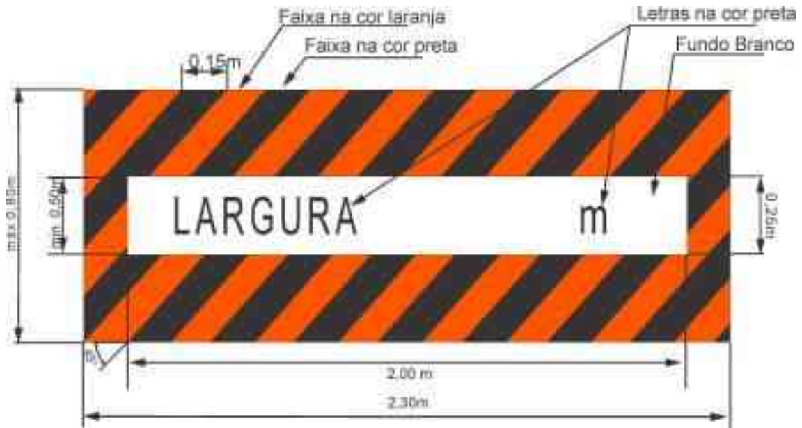
Figura 3: Sinalização especial de advertência traseira para largura excedente
